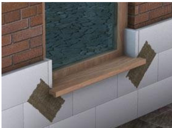
Рис. 16 Утепление оконных и дверных откосов
