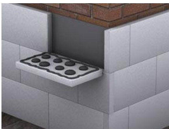
Рис. 14. Наклейка утеплителя на стену
