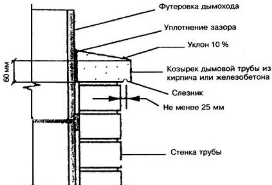
Рисунок 7.7- Оголовок дымовой трубы
