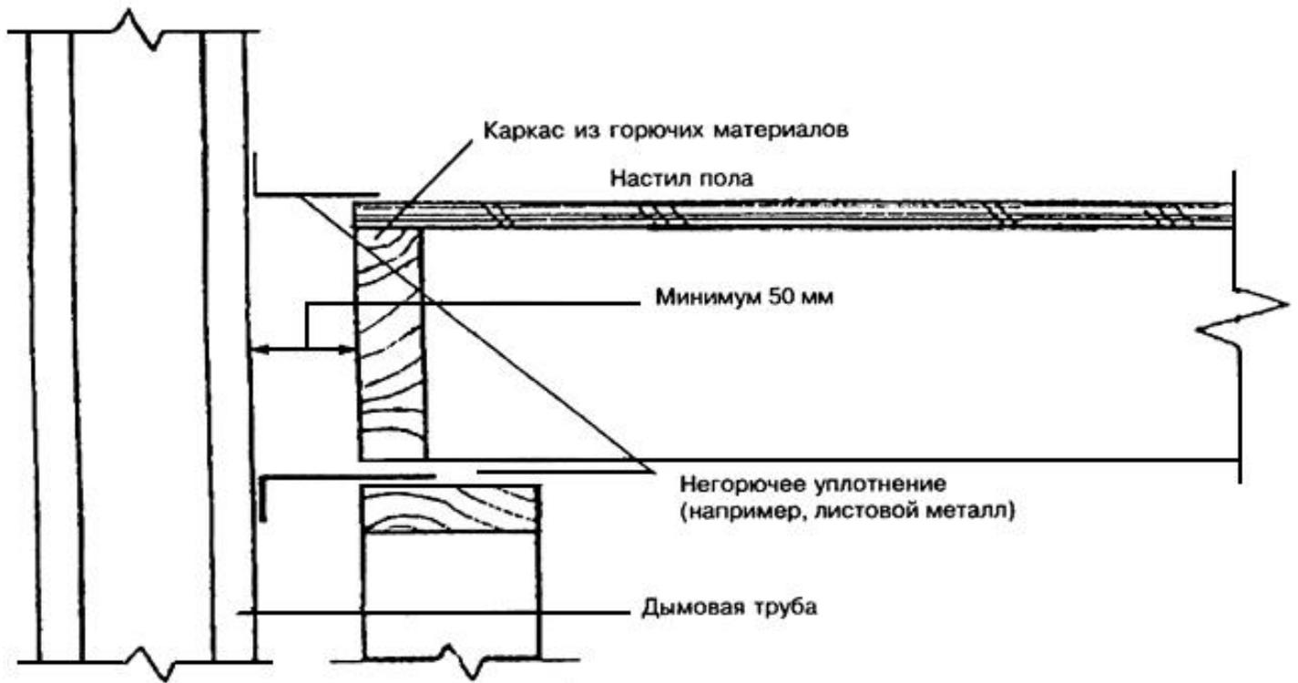
Рисунок 7.8 - Расстояние от дымовой трубы до строительных конструкций
