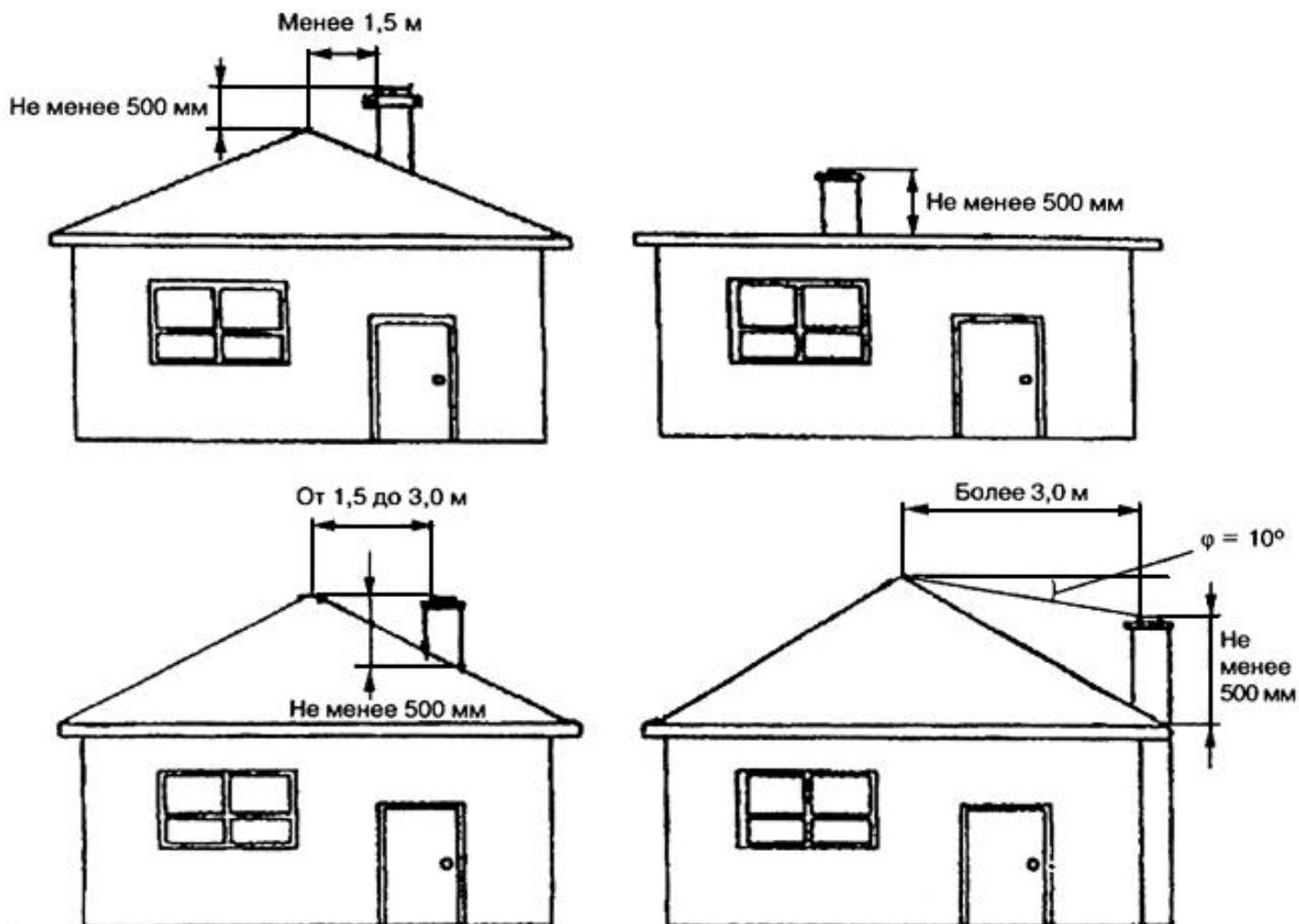
Рисунок 7.9 - Минимальная высота дымовой трубы
