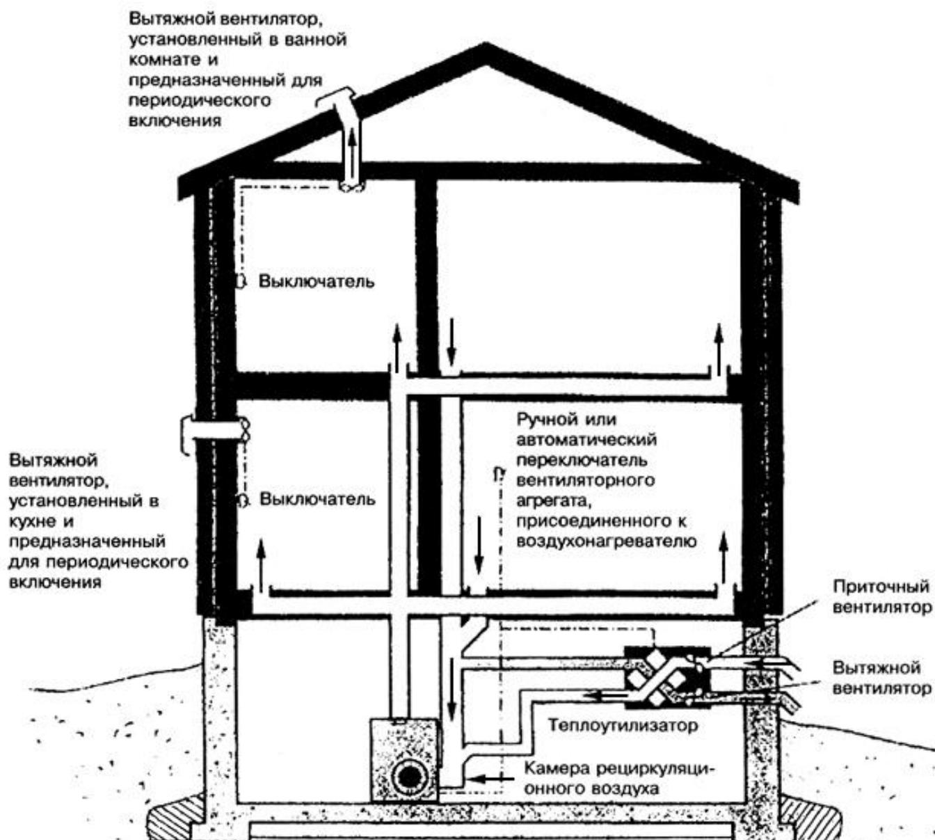
Рисунок 7.3 - Присоединение теплоутилизационного агрегата к камере подогрева воздуха
